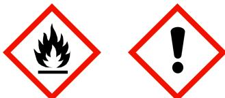
**Gefahrenhinweise**H225 Flüssigkeit und Dampf leicht entzündbar.
